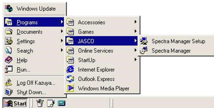
於 Spectra Manager 之功能表中任一測量程式，啟動電腦與主機的連線，如連線正常，螢幕會顯示 **Initializing**，表示主機正在啟動，當 **Spectra Manager** 左下方顯示 **Idle**，表示主機已啟動且處於待命狀態。
